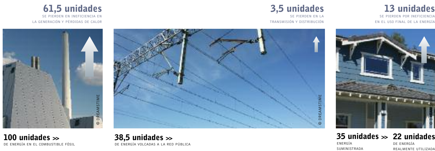
figura 3.2: el sistema centralizado desperdicia más de 2 tercios de la energía
