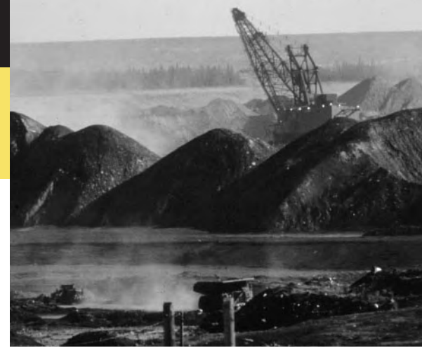
Exploitation des sables bitumineux en Alberta. Le camion à l'avant-plan sur cette image semble petit, mais il fait près de 3 étages de hauteur et pèse 320 tonnes. Le « bras » de la grue mesure 100 mètres. L'extraction de pétrole des sables bitumineux est une des plus importantes sources d'émissions de gaz à effet de serre au Canada.
