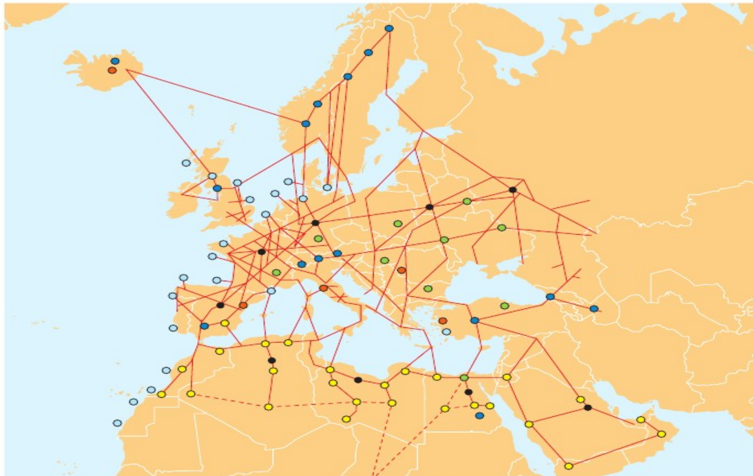
Figure 6.1 Modelo de líneas de interconexión en corriente continua a alta tensión (HVDC) para exportar la electricidad procedente de las centrales eléctricas termosolares desde el norte de África a Europa
