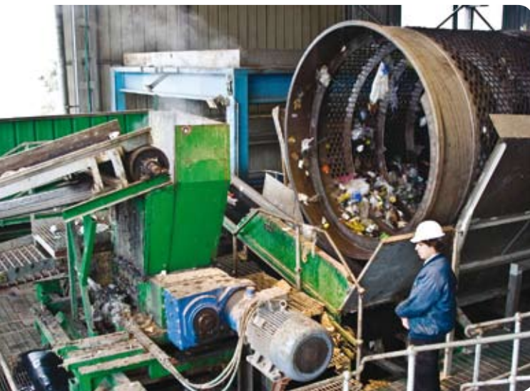
Из вращающегося барабана на конвейер поступает только относительно крупный мусор
