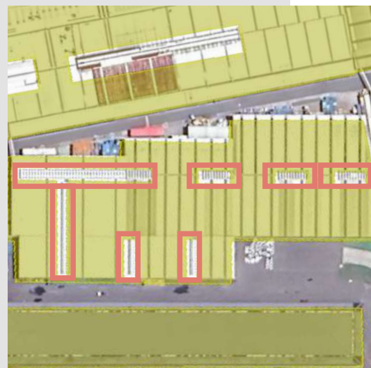
▲ 圖3 有排氣孔等設備之屋頂中脊排除不計 (圖為台玻新竹廠)
