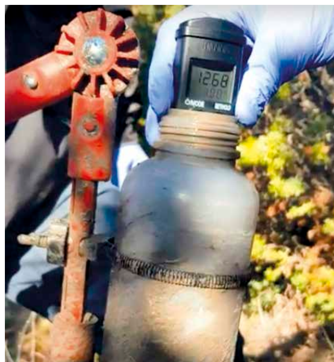
Фигура 12. Пробата от суспензия от възлищна пепел (BG19008, 13 март 2019 г.) е високоалкална (pH = 12.7)
