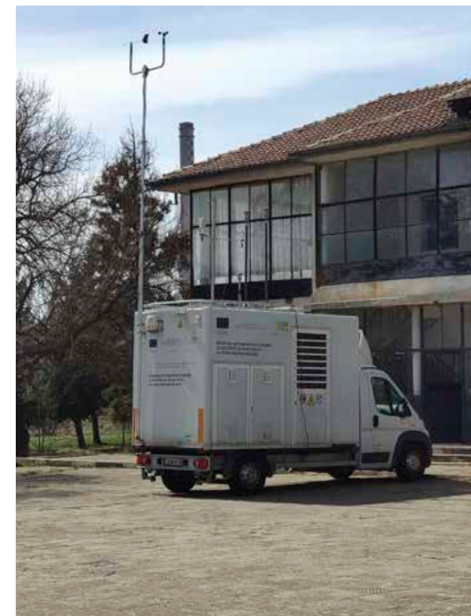
Фигура 14. Мобилната измервателна станция на ИАОС
