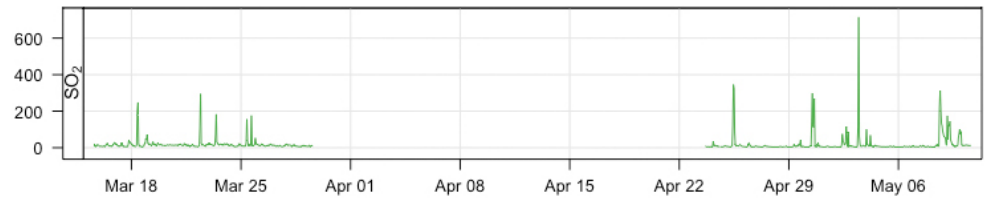
Фигура 20. Отчетени средночасови концентрации на SO 2 (µg/m 3 ) от мобилната измервателна станция през два периода на мониторинг в Големо село през 2019 г.
