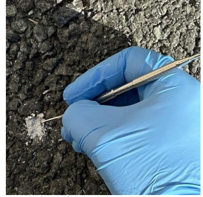
Abb. 3: Ist die Oberfläche mit weißen Einschlüssen durchzogen und lässt sich mit einem Metallgegenstand ohne viel Druck eindrücken, handelt es sich mit hoher Sicherheit um Asbest.
