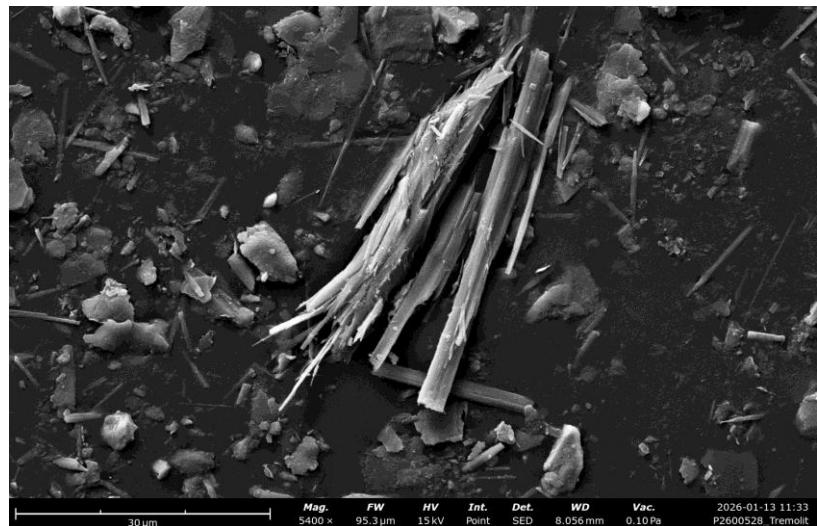
**Untersuchung von Materialproben auf Asbest gemäß VDI-Richtlinie 3866, Blatt 5, 2017-06**
