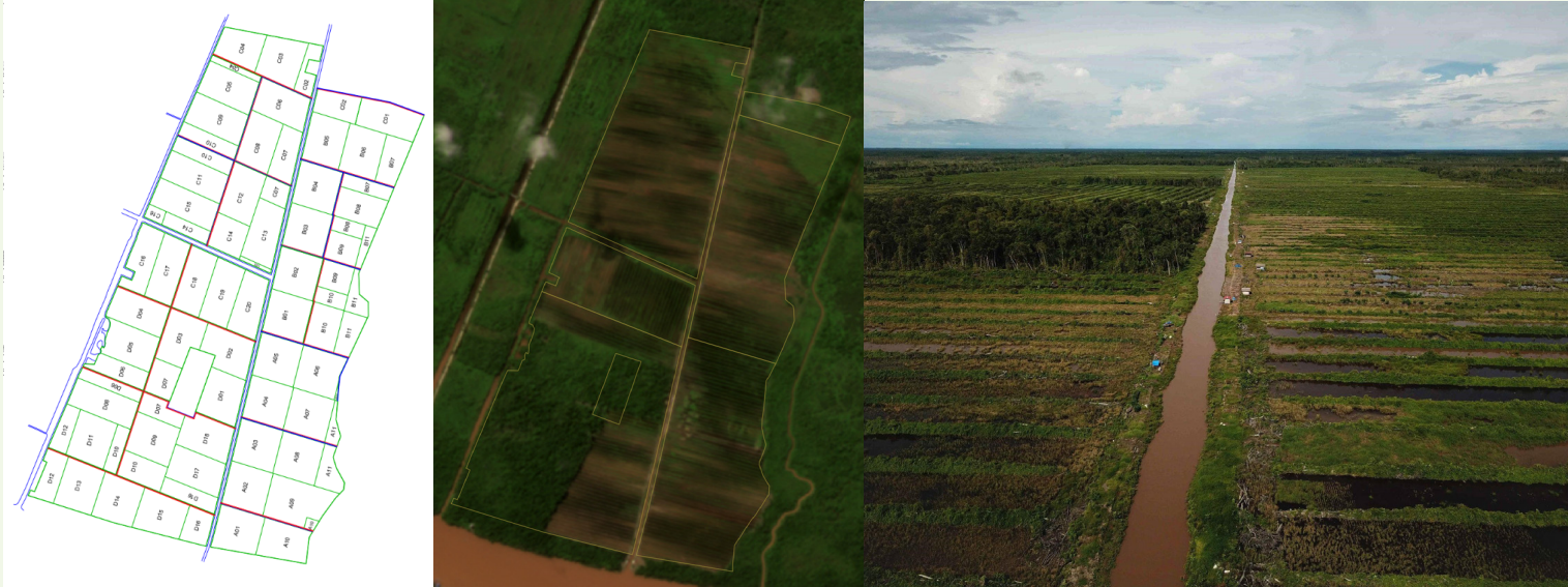
Rencana persawahan Desa Lamunti (kiri); kondisi sawah yang terlihat melalui mosaik Planet Imagery (tengah); foto yang menggambarkan kondisi sawah sebagaimana terlihat dari udara pada 30 Juli 2022 (kanan). Berbeda dari rencana, kontraktor membangun sawah dalam bentuk memanjang, sehingga menyulitkan petani untuk memanen bidang tanah mereka masing-masing. Greenpeace (2°35'35.2"S 114°24'26.3"E).
