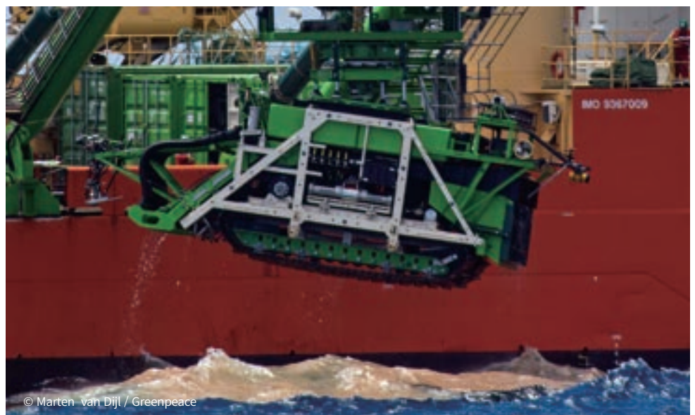
Sedimento en la superficie procedente de un colector de nódulos testado por una de las principales empresas mineras submarinas.
