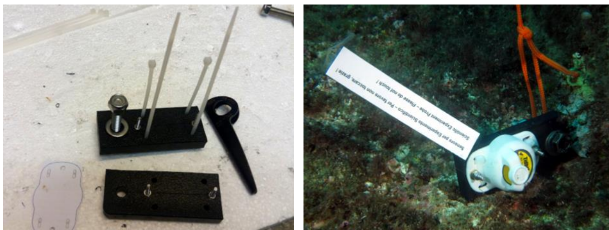
Figura 13. Nella foto a sinistra si osserva il chiodo da roccia del tipo narrow angle e il supporto con le fascette sul quale sono installati i sensori. Nella foto di destra si osserva un sensore installato sul supporto e segnalato dall'etichetta e dal galleggiante fissato con la cima.
