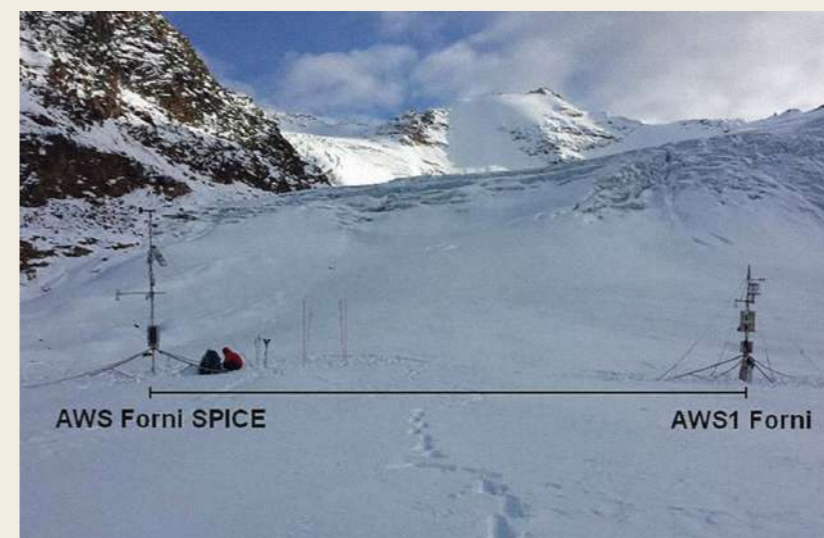
Foto 1. Le due stazioni meteorologiche automatiche installate sulla superficie del Ghiacciaio dei Forni
