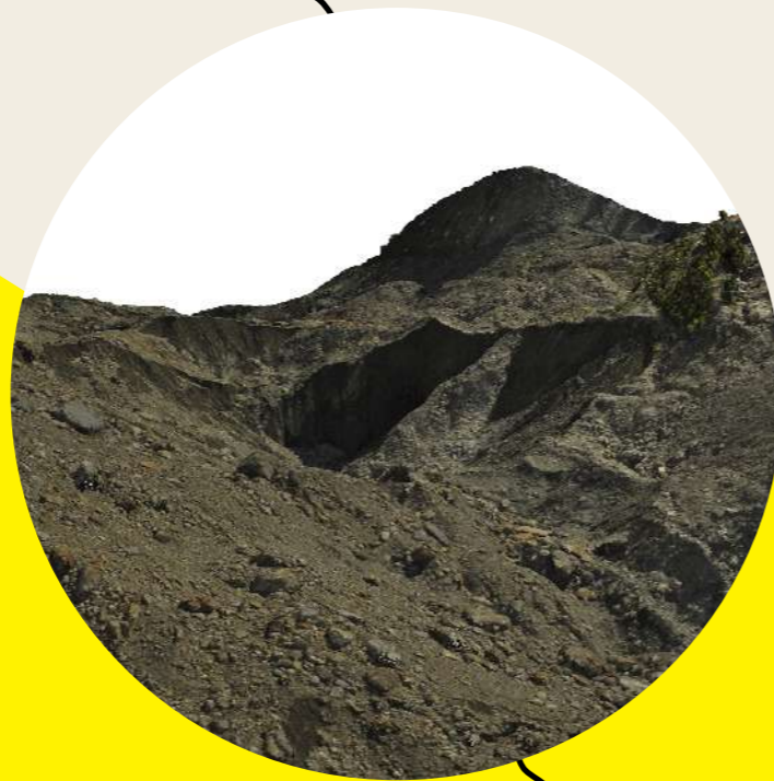
Figura 7. Vista della nuvola di punti 3D ottenuta dal rilievo fotogrammetrico con drone effettuato il 02/09/2023.
