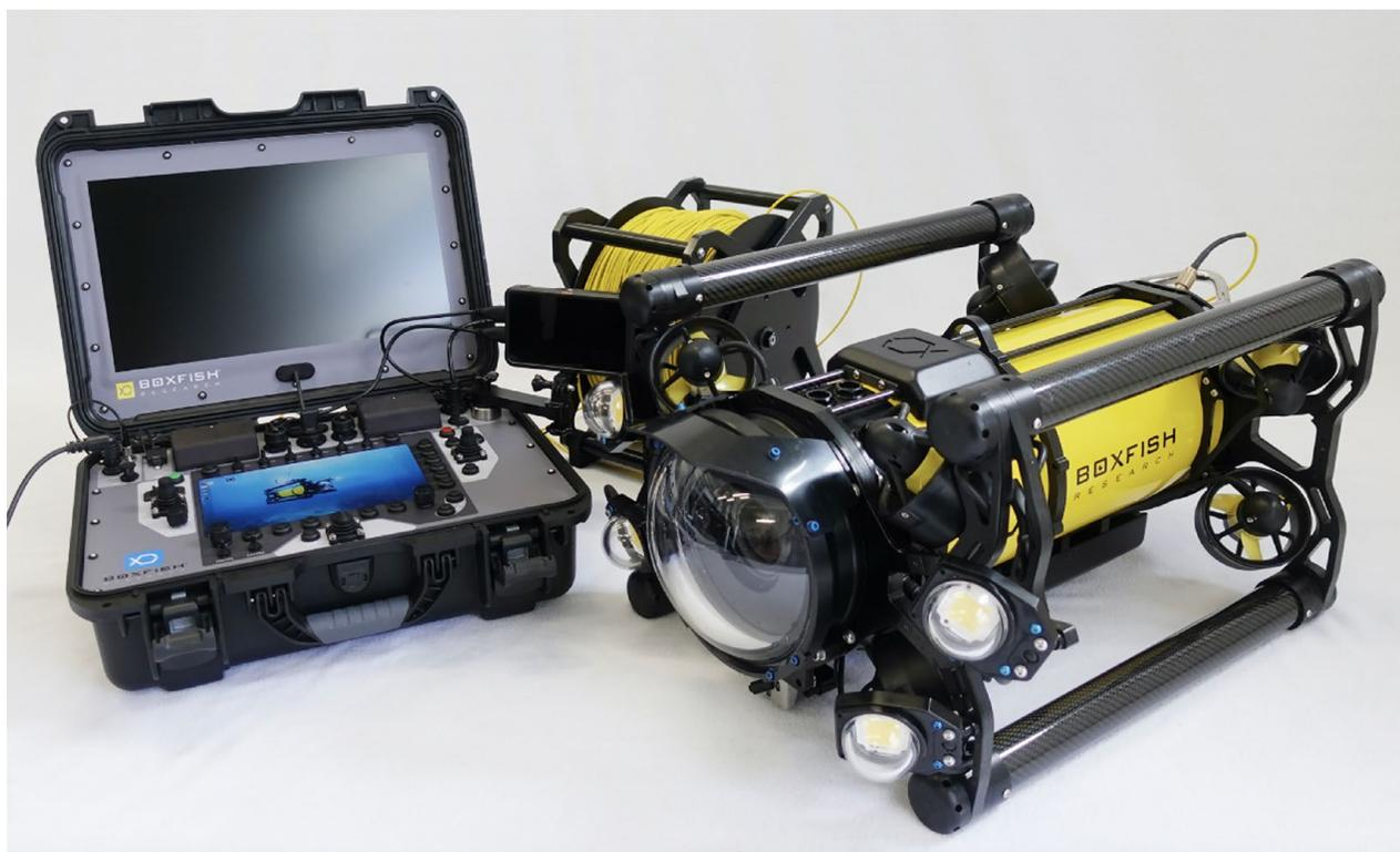
**Figura 5.** Vehículo operado de manera remota (ROV, por sus siglas en inglés) modelo *Boxfish*.
