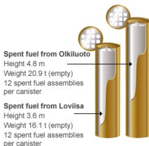
Figuur 20 Cilinder voor directe opslag van brandstofstaven
