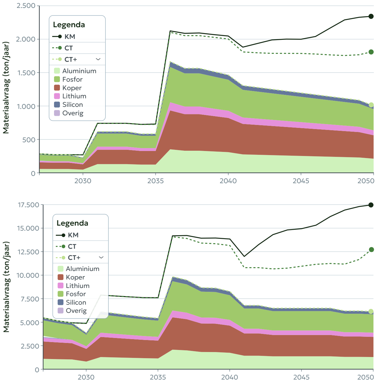
Figuur 10a en 10b | Materiaalvraag van systeem- en thuisbatterijen in het CT+ -scenario, in vergelijking met CT en de baseline (KM).
