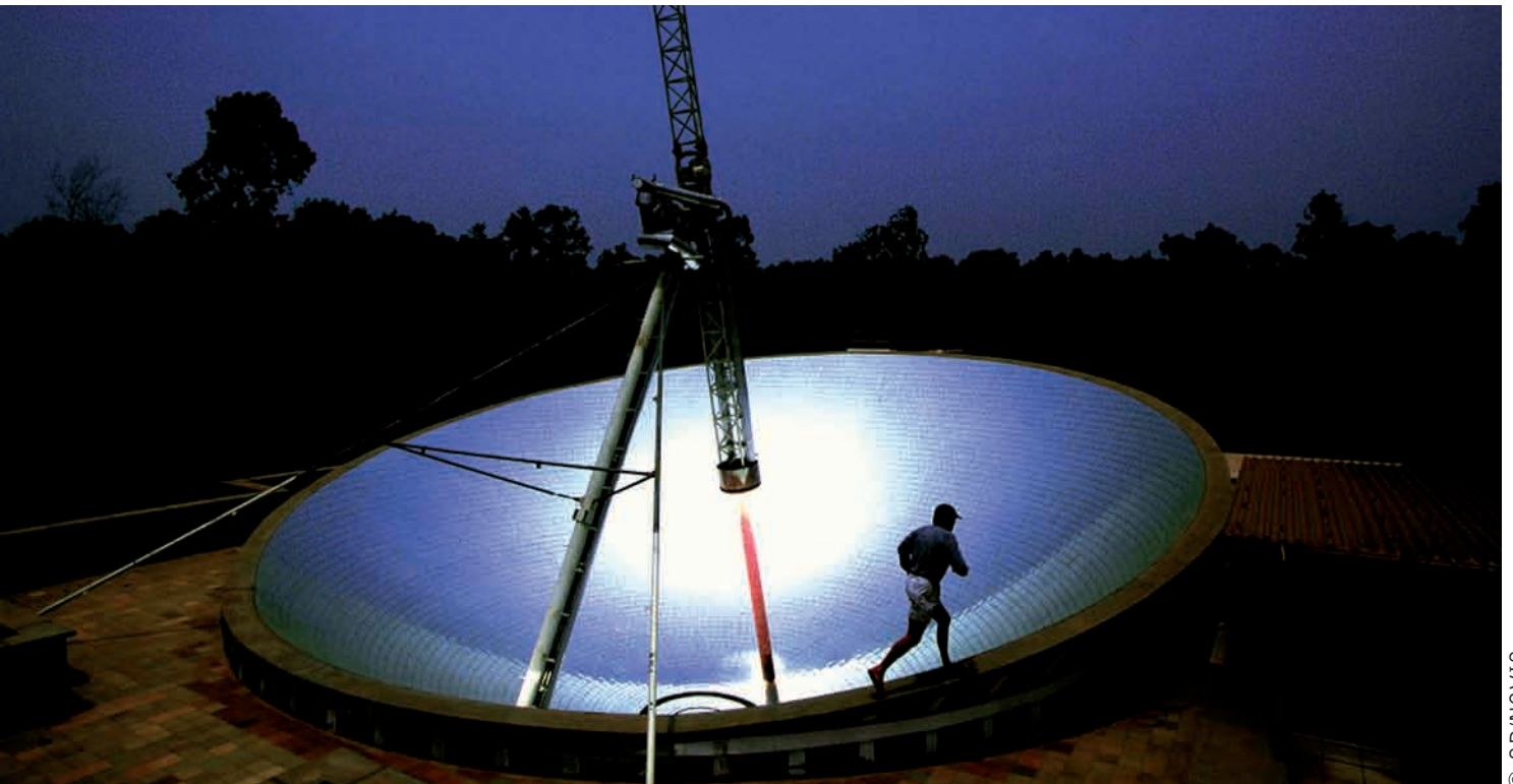
Słoneczna misa, zasilająca kuchnię w Auroville, Tamil Nadu, Indie; wychwytuje dość energii, by ugotować posiłki dla 2000 osób dziennie
