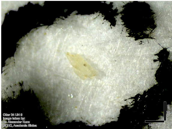
圖三：立體顯微鏡下發現透明的塑膠碎片，經拉曼光譜確認材質為PP
