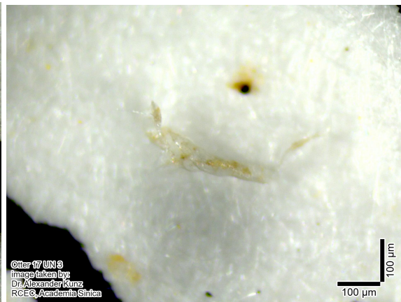
圖四：立體顯微鏡下發現透明的塑膠碎片，經拉曼光譜確認材質為PE
