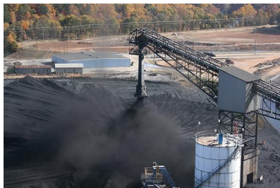
รูปที่ 16 ตัวอย่างการเกิดฝุ่นจากขั้นตอนในการทำเหมืองถ่านหิน เช่น (a) การระเบิดเพื่อเปิดหน้าเหมือง (Dust-A-Side Australia 2021) (ALS 2017) (b) การขนส่งแร่ด้วยรถบรรทุก (Atfield 2017) และ (c) การลดขนาดและกองเก็บถ่านหิน (Nowling 2016)
