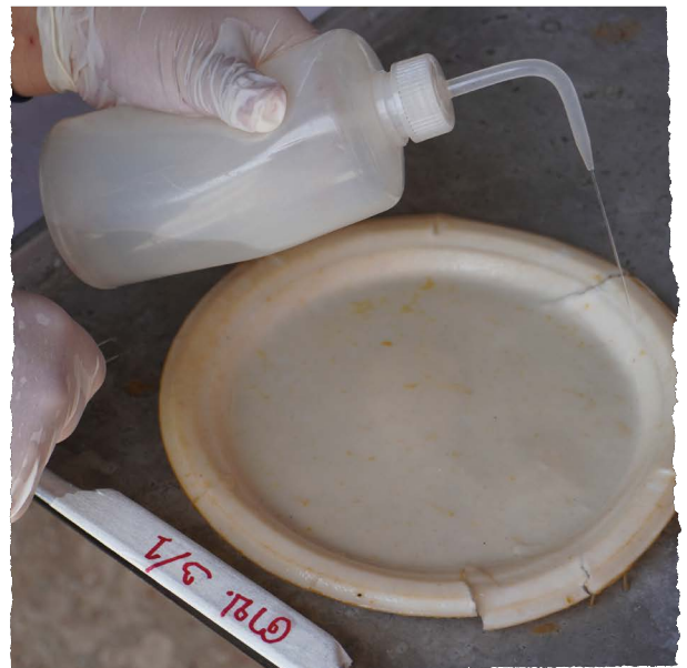
นักวิจัยใช้น้ำกลั่นชะล้างสิ่งที่หลุดออกมาจากผลิตภัณฑ์ เพื่อนำไปวิเคราะห์ว่ามีไมโครพลาสติกหรือไม่
