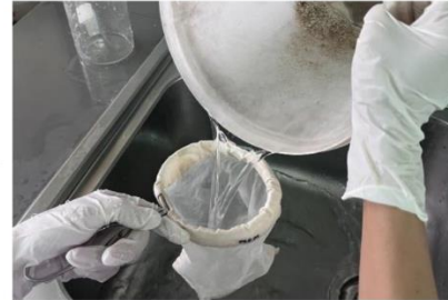
2. ล้างตัวอย่างดินผ่านถุงกรองขนาดตา 0.3 มิลลิเมตร และแยกตัวอย่างดินออกเป็น 2 ส่วน คือ ส่วนที่รินผ่านถุงกรอง (Jar B) และส่วนที่เหลือในภาชนะ (Jar A)
