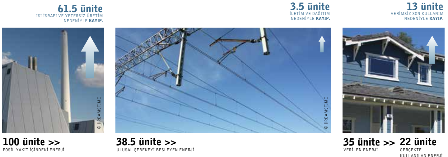
şekil 2.1: Merkezi üretim sistemleri, orijinal enerji girdilerinin üçte ikisinden fazlasını kaybeder
