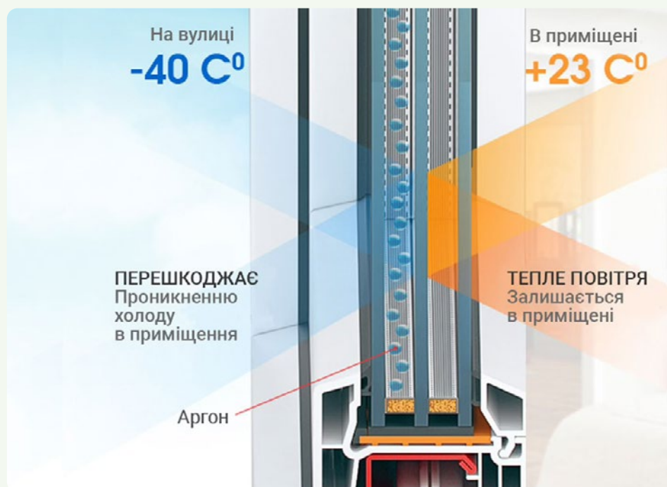
Рисунок 6. Правильний вибір віконної конструкції: принцип роботи
